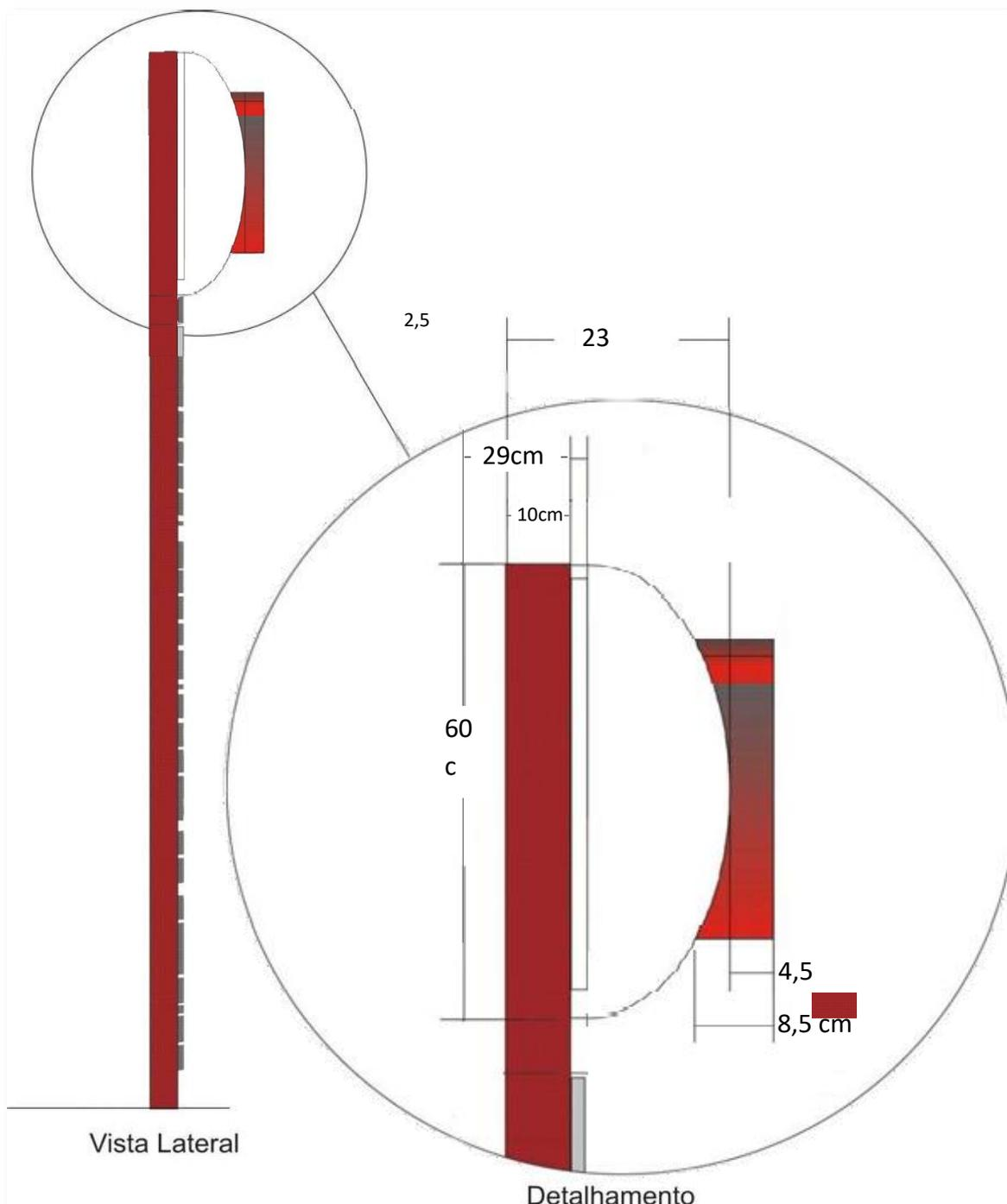
\*Observação: A Coluna Lateral terá do lado externo (esquerdo de quem está de frente para a placa) 10cm de profundidade e do lado interno (direito de quem está de frente para a placa) 29 cm no total. Pois do lado esquerdo é
